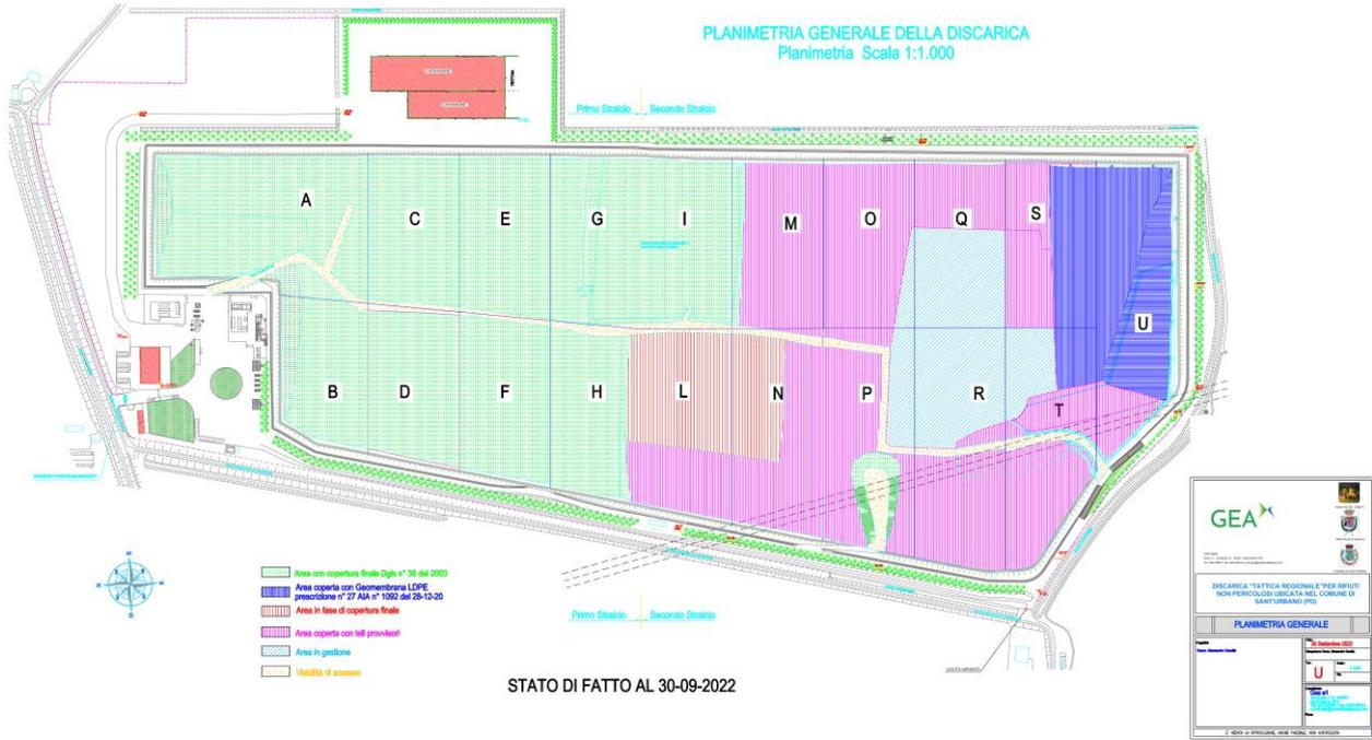
Figura 3: Planimetria dello stato di avanzamento lavori con evidenziate l'area in gestione, l'area in copertura provvisoria con teli in HDPE/LDPE e l'area in copertura finale come da D.Lgs. 36/03 (aggiornata al 30/09/2022)
