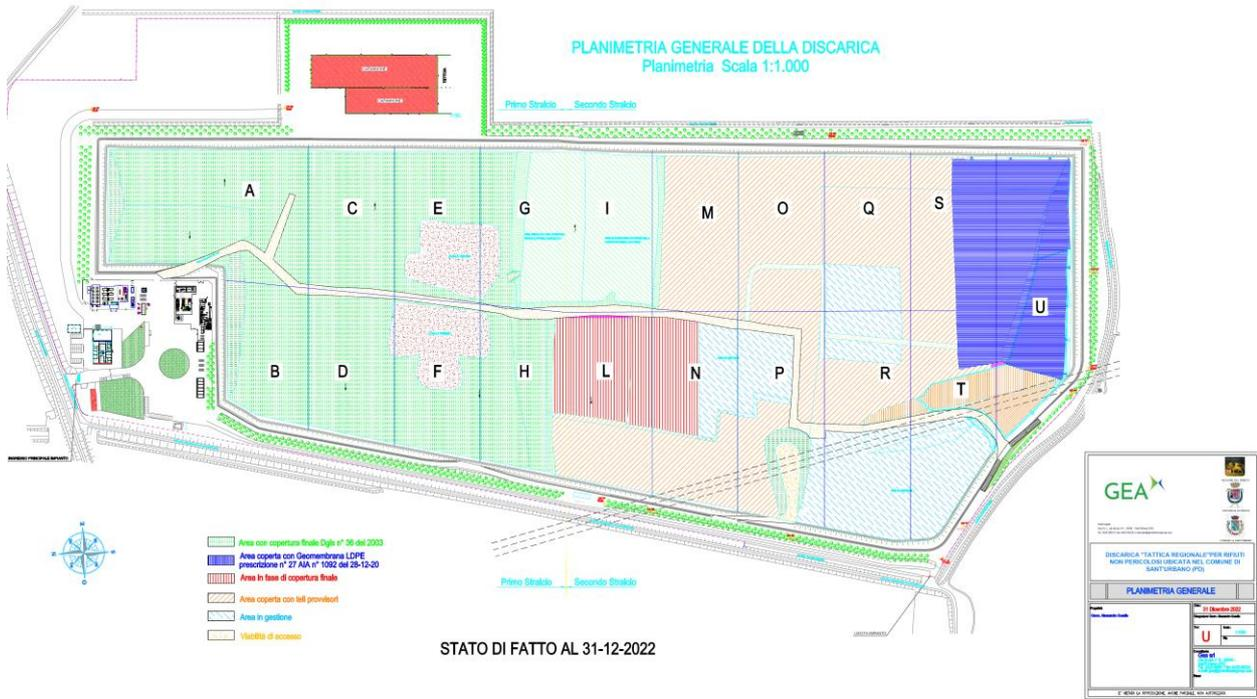
Figura 3: Planimetria dello stato di avanzamento lavori con evidenziate l'area in gestione, l'area in copertura provvisoria con teli in HDPE/LDPE e l'area in copertura finale come da D.Lgs. 36/03 (aggiornata al 31/12/2022)
